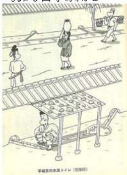
圖 3 平城京的廁所，以水槽引公共水溝之水作跨溝廁所，再以水槽排回公溝
