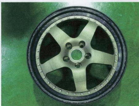
彎曲測試後-正面
