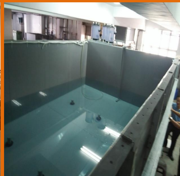
養殖魚槽槽體組合完成部 操作容水量：31,000L
