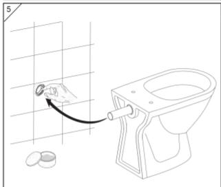
在直管與彎管的結合處抹上潤滑油(如硅油) 注:可先將直管插入便器,再根據相配套便器的 安裝説明書要求安裝便器.
