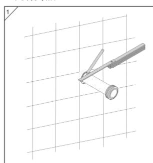
取出堵頭杆套,將直管插入彎管,直到不能前進,畫出直管與墻面的交綫.
