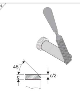
將鋸短後的圈口直管按圖示
