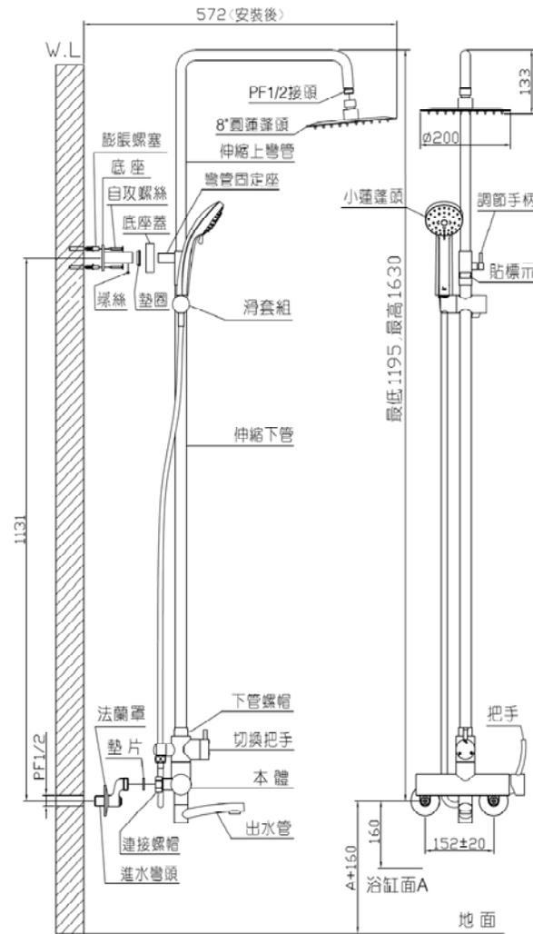
\*A為浴缸安裝後高度, 一般為 $470\text{mm}$
