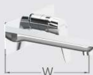
LF21003 臉盆龍頭 (嵌牆式) 尺寸 | W:183mm 適用水壓範圍 | 0.5~5kgf/cm 2
