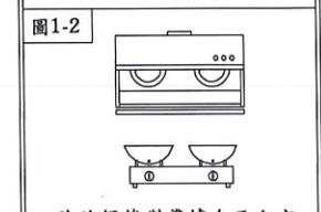
3. 按裝後之機體不能歪斜應保持水平，否則集油盤(或集油杯)內積油將傾向單邊而溢出機體外。
