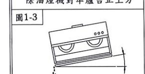
4. 排風出口至機體之距離，應儘量避免過長，以免氣流擠壓於管內，影響其排風效果。
