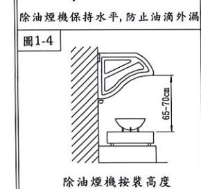
5. 除油煙機之按裝高度係以爐面至機體前緣端面之距離，參考高度為65-70cm。(圖1-4)
