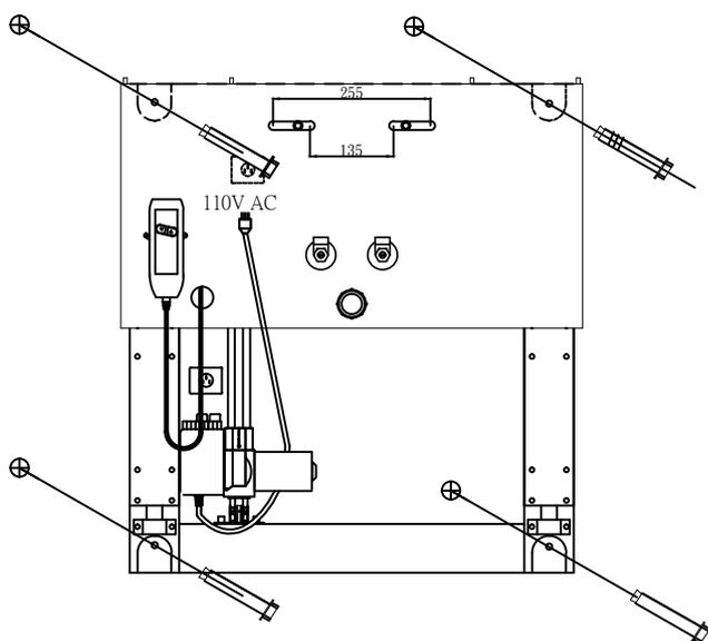
4 將電源插頭插入插座, 操作控制器檢查升降組升降功能是否正常. 機能檢查後將昇降組升到最高位置(本機使用電源110V, 插入前請確認電源為110V)
