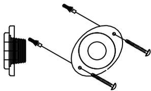
5-1 將排水管及進水管連接於牆上接頭處
