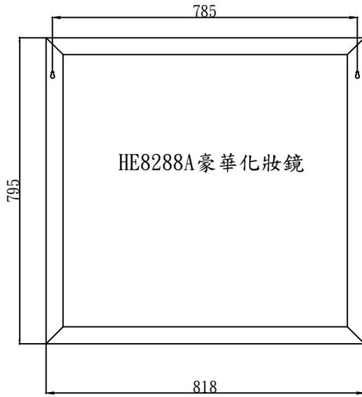
依下圖掛孔位置, 鎖入吊掛螺絲, 再將化妝鏡掛上
