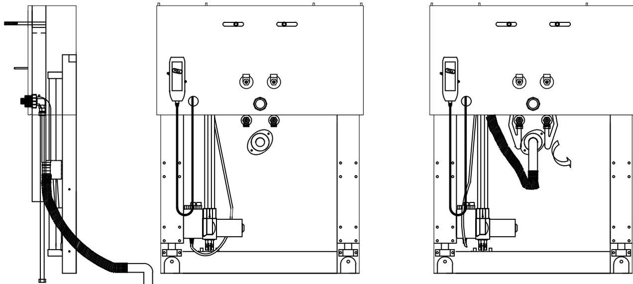
6. 安裝臉盆, 並將水管及排水管路接到連接座處
