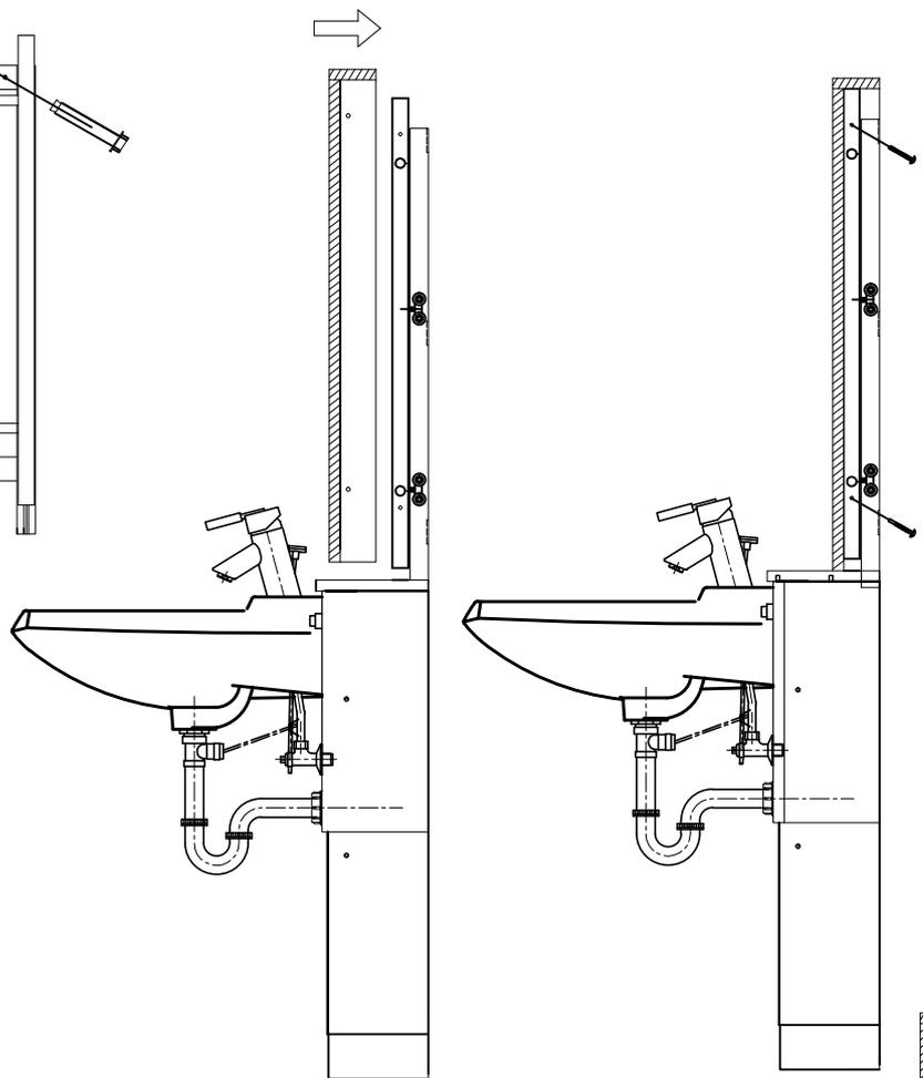
5. 將面板固定好，操作控制器昇降升降組，檢視面板與固定牆間是否有抵觸(若有抵觸，依狀況進行調整)
