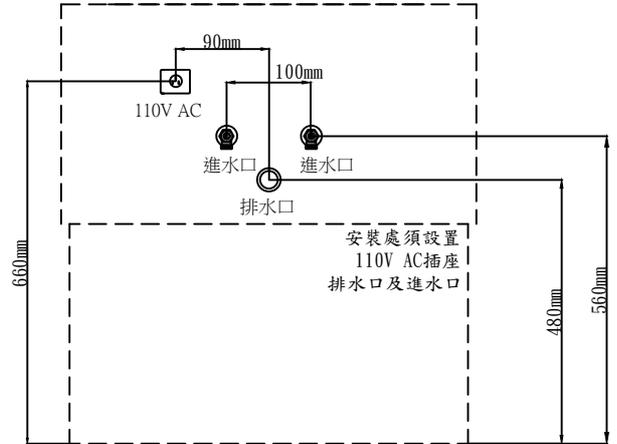
3. 請確認安裝鑽孔處, 內部沒有水管或電線
