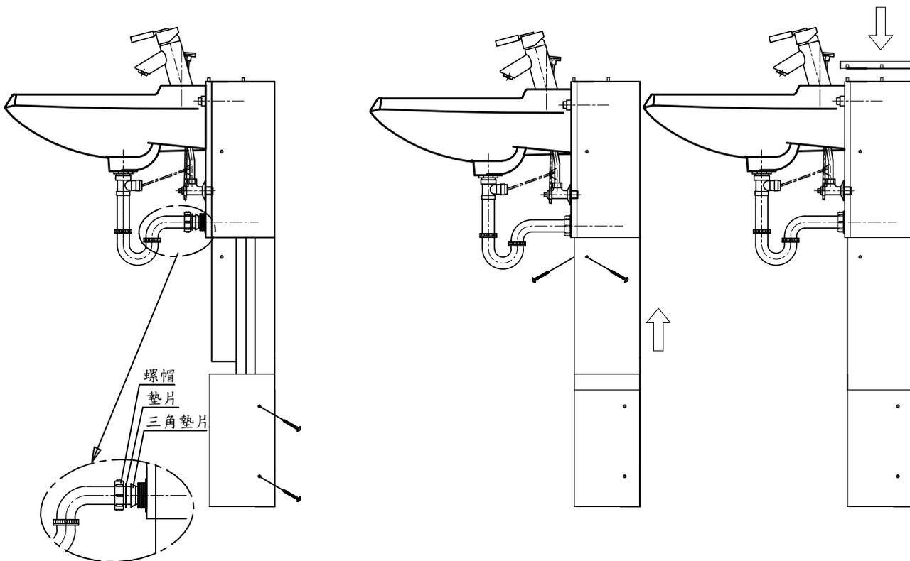
註: 請依序將螺帽、墊片、三角墊片放入 L 管中, 將 L 管對準螺紋管內 放入後將螺帽旋緊。
