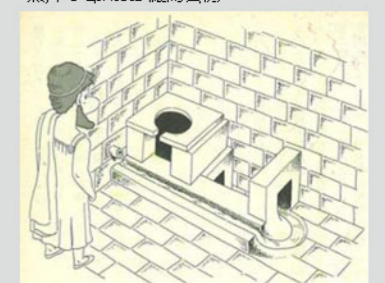
圖 2：羅馬的沖水廁所示意圖前面水溝可洗淨肛門
