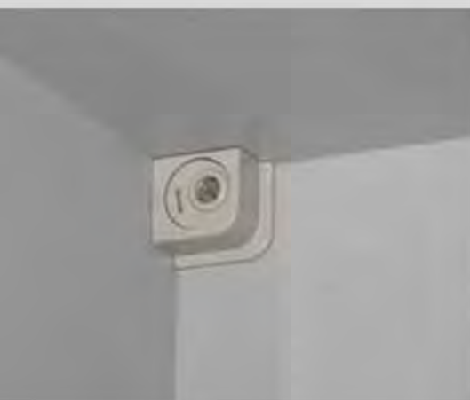
日本特殊功能的桶身吊金具 櫥櫃懸吊可上下左右前後3D調整。外部材質為ABS樹脂耐衝擊性佳。單邊承重60KG，雙邊120KG。
